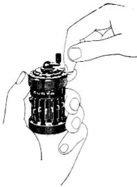
**WICHTIG:** Nur wenn der Löscherhebel in einer seiner beiden Grundstellungen steht, kann der Wagen wieder in seine untere Stellung zurückschnappen und die Kurbel betätigt werden. Als Vorbereitung zur nächsten Übung führen Sie nun bitte einige Kurbeldrehungen aus.
